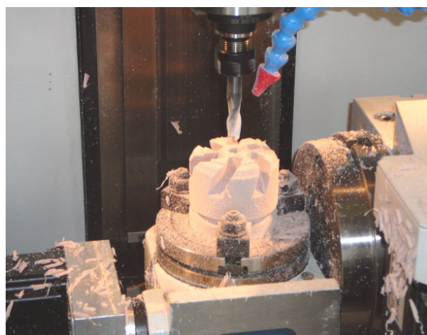
Kinematická koncepce použitá na frézce FCM 16 CNC
